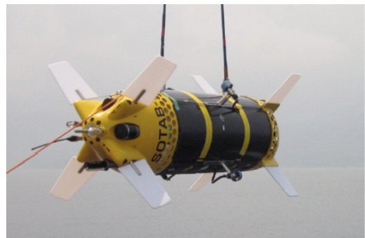
図 1 自動追跡海中ロボット (SOTAB-I)
