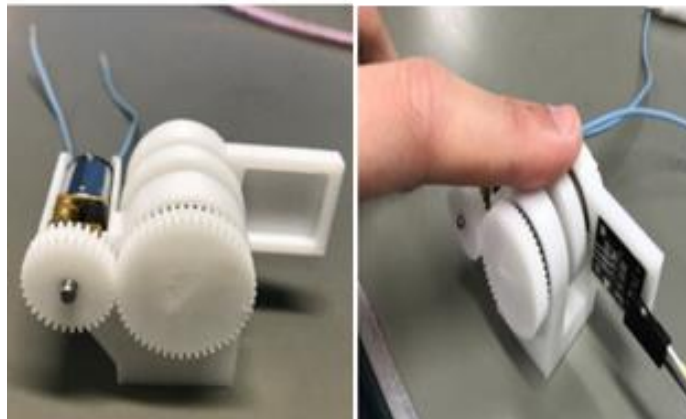
図 2 剪断刺激提示装置. 将来的には指先に装着するウェアラブル化を目指しており, 小型なものを製作した. 右図は実験時の示指の触れ方を表す.
